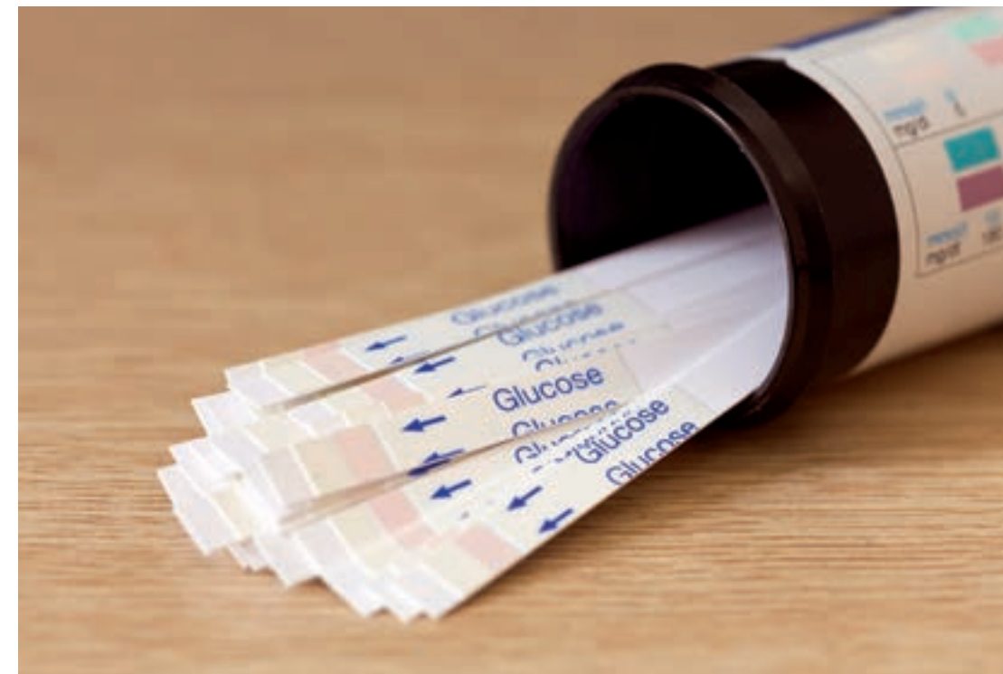
Bei der optischen Messung reagiert der Teststreifen chemisch mit dem Blutzucker
